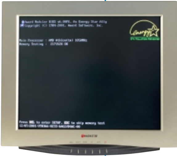
Arriba. Al encender el PC, el BIOS detecta el procesador y chequea la memoria RAM del sistema; además, nos indicará la forma de acceder al Setup.
